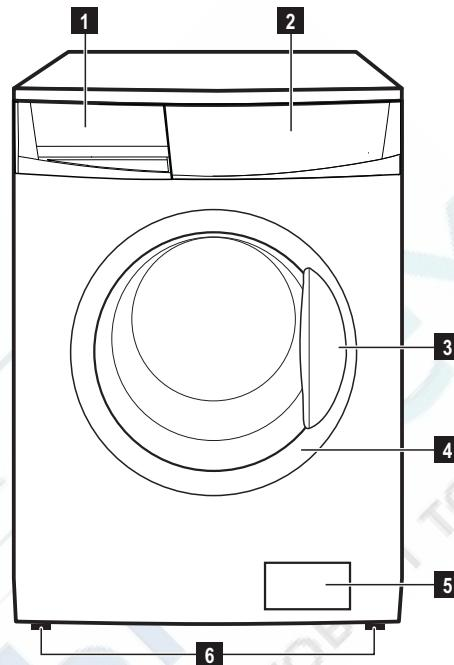
■ Отделение для моющего средства, используемого при предварительной стирке и вымачивании, или для пятновыводителя, используемого на этапе выведения пятен (если имеется). Моющее средство для предварительной стирки и вымачивания добавляется в начале выполнения программы стирки. Пятновыводитель добавляется на этапе выведения пятен.
