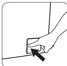
Закройте дверцу фильтра сливного насоса.
