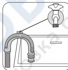
Подвесить над краем раковины, используя пластмассовую направляющую, входящую в комплект поставки машины.
