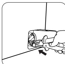
Установите на место заглушку отверстия аварийного слива и плотно закрепите ее.
