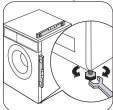
При необходимости проверьте точность выравнивания с помощью уровня.
