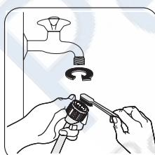
Закройте кран подачи воды. Отвинтите наливной шланг. Прочистите фильтр жесткой щеткой. Привинтите на место наливной шланг.
