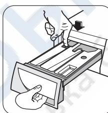
Извлеките дозатор, отжав вниз защелку и потянув его на себя. Промойте его под краном, чтобы удалить все остатки скопившегося в нем порошка.
